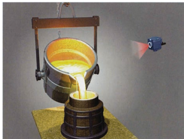
采样锅的劣化监视
