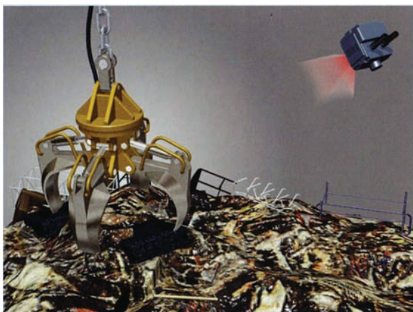
垃圾堆场的升温监视
