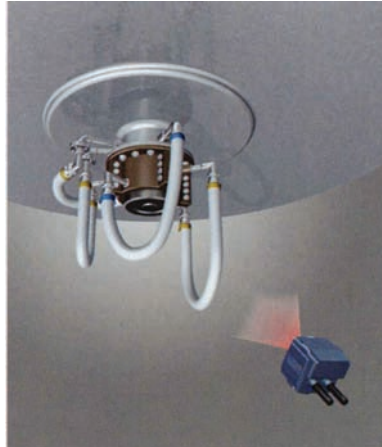
炉底的劣化监视
