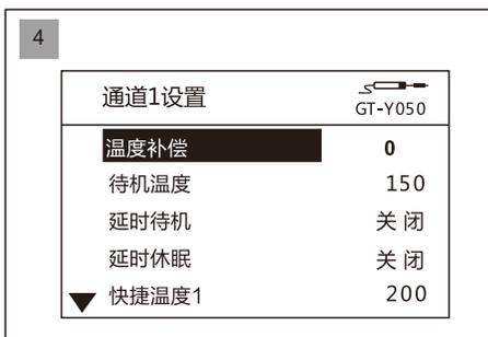
需要进入通道设置页面时，必须要在对应手柄通道接入正确的手柄。在系统设置界面，使用按键“1”和按键“3”选择要进入的通道。
