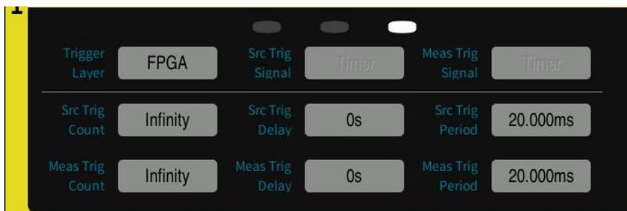
图 4-11 通道具体设置页面 3—FPGA 触发层
