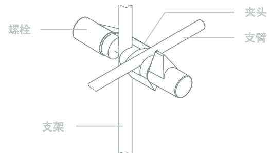
使用前，请检查搅拌器是否牢固的固定在所需的位置，并周期性的检查。只有当搅拌器停止运转，电源断开时才可以调整搅拌器位置。
