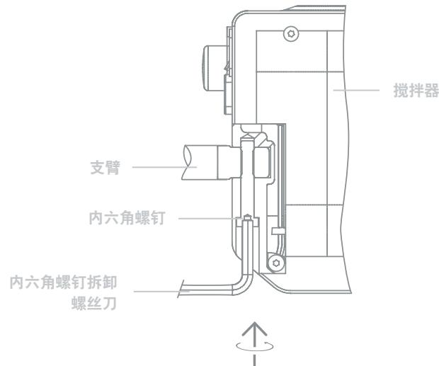
请确保支臂安装牢固。振动可能导致螺丝松动，因此，使用时请经常检查支臂是否牢固，如有必要，请拧紧固定螺丝。
