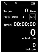
无线控制器打开数秒后, 出现开机屏幕, 屏幕显示仪器名称、软件版本。之后, 此工作屏幕出现。
