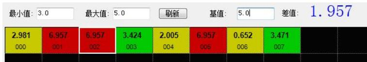
g、“基值”，用户可根据一批工件的平均厚度，设置一个基准值，用鼠标点击一个栅格，栅格中的厚度值会与基准值相减，结果显示在“差值”的后面；
