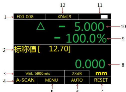
1-数据的组号—数据号 2-标称数值 3-声速 4-A扫描切换标识 5-菜单标识 6-测量模式 7-清除当前测量值 8-当前厚度值 9-差值与标称值的百分比 10-当前厚度值与标称值之差 11-电池电量 12-探头型号
