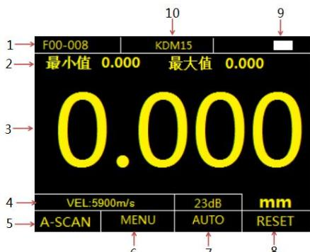
测量值 9-电量指示 10-探头型号
