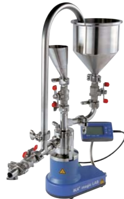
magic LAB® 配合 CMS 模块和配件 > 用于将粉末 / 颗粒分散到液体的循环处理
