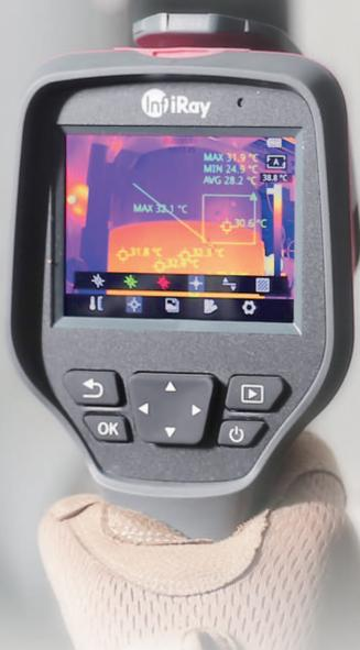
艾睿光电M200F是天璇系列256×192分辨率的又一扛鼎之作。五大产品优势，配合艾睿光电Altemp精确测温算法、Matrix III高清图像算法、InfiRay云端功能体验，竭力为电气检修、电路设计领域提供图像高清、大屏显示、测温精准的专业红外热像仪工具。
