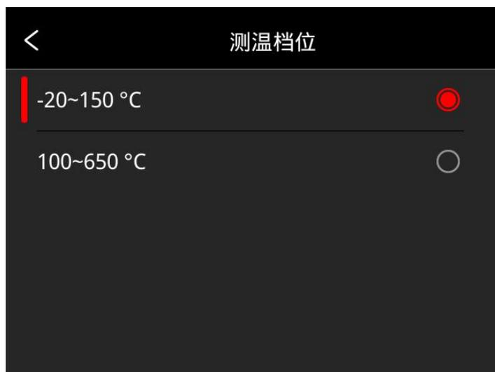
通过导航键上下移动光标选中所需档位，短按 ok 键即可切换成功；触屏点击所需档位也可自由切换档位。
