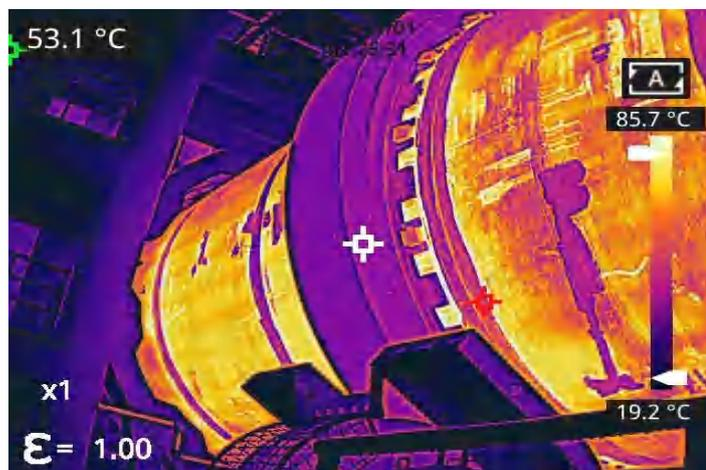
回转窑耐材缺陷监测
