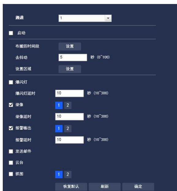
图 3.4-1 视频检测-动态检测设置
