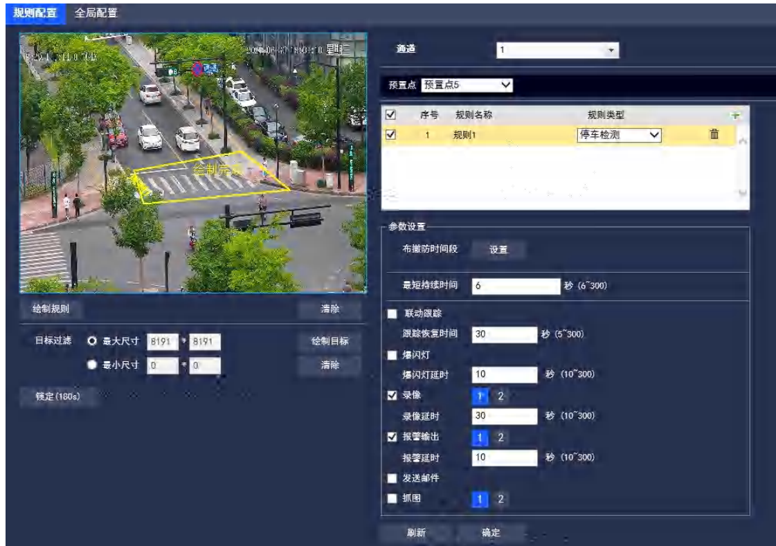
图 3.4-20 停车检测设置
