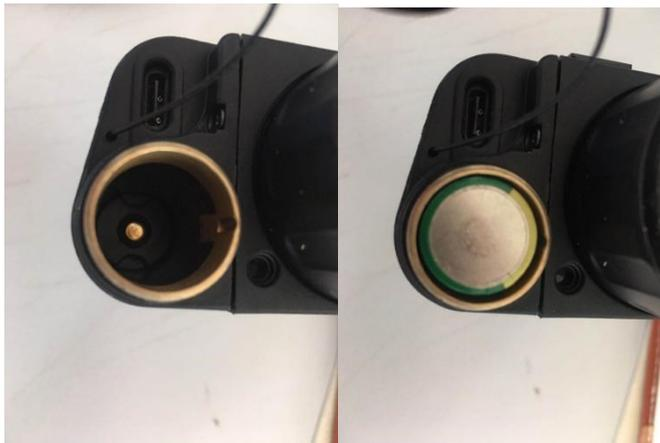
图 5-1 电池安装示意图
