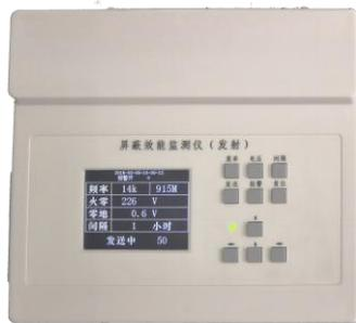
图 4 发送端主面板
