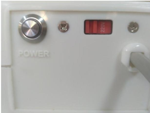
图 1 开关按钮及电源转换开关
