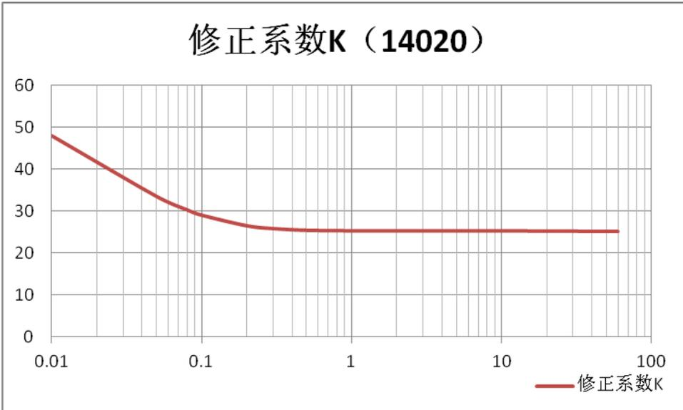
X 轴: 频率 (MHz), Y 轴: 修正系数 (dB)
