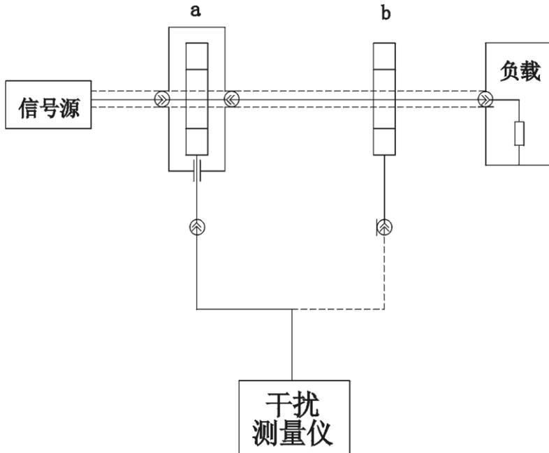
高频电缆一端接有匹配的终端负载，另一端通过测试连接器接到高频
