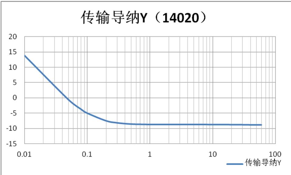
X 轴：频率 (MHz)，Y 轴：传输导纳 (dBs)
