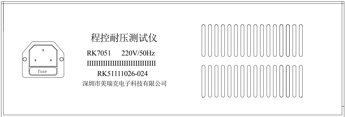
图 (6.2) 7051 耐压测试仪后面板示意图
