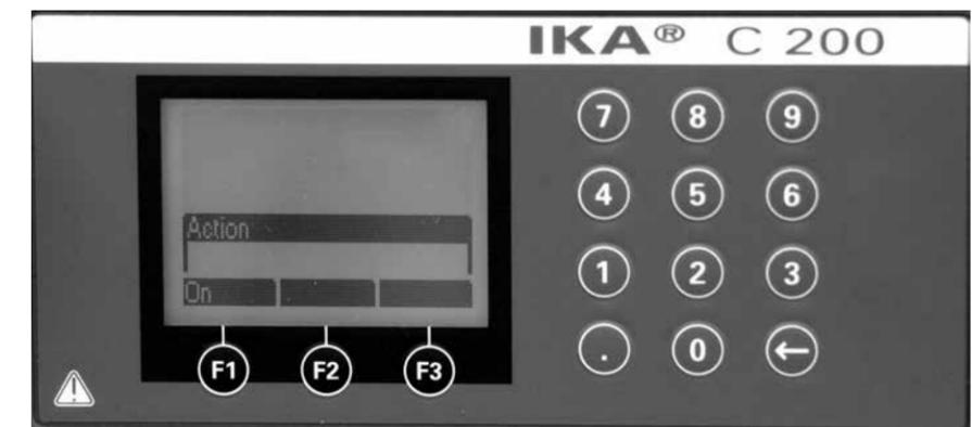
按下 **ON (F1)** 按键打开仪器，显示屏显示开机屏幕。
