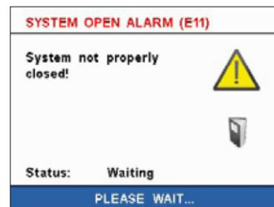
测量时系统上盖无法正常闭合。
