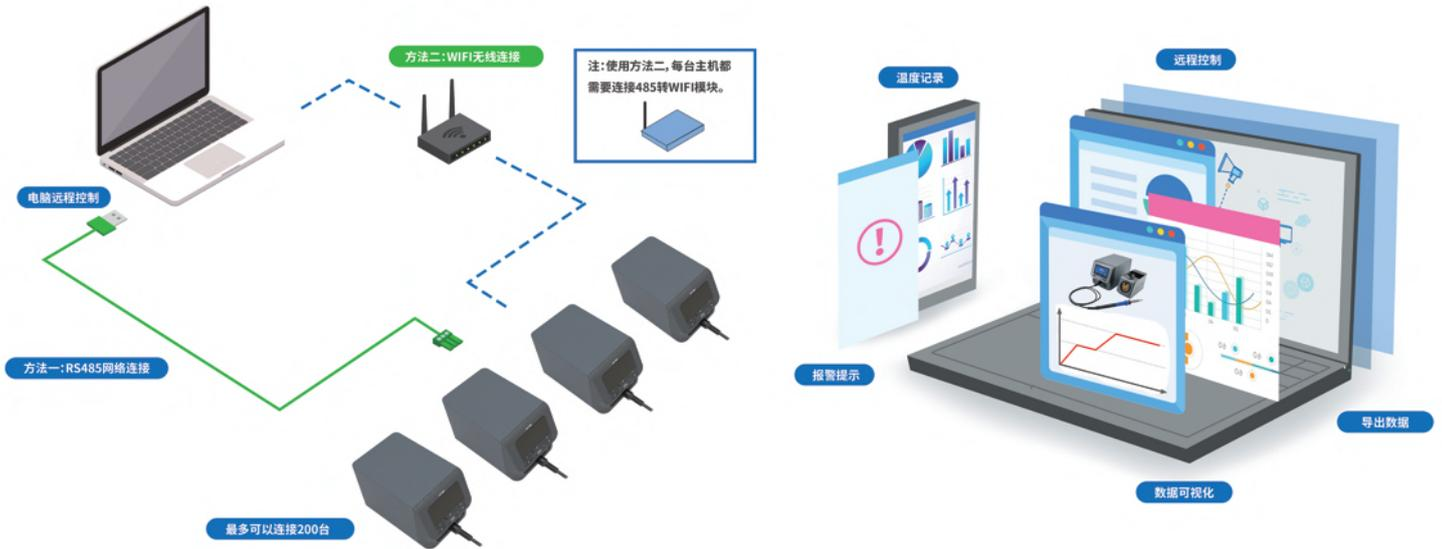
焊台内置485通信模块（也可外置无线通信模块），可对接智能管理平台软件系统，实现：互联实时监控，工艺保存复制，数据存储追溯，统计分析管理，监控报警提示，远程操作控制。
