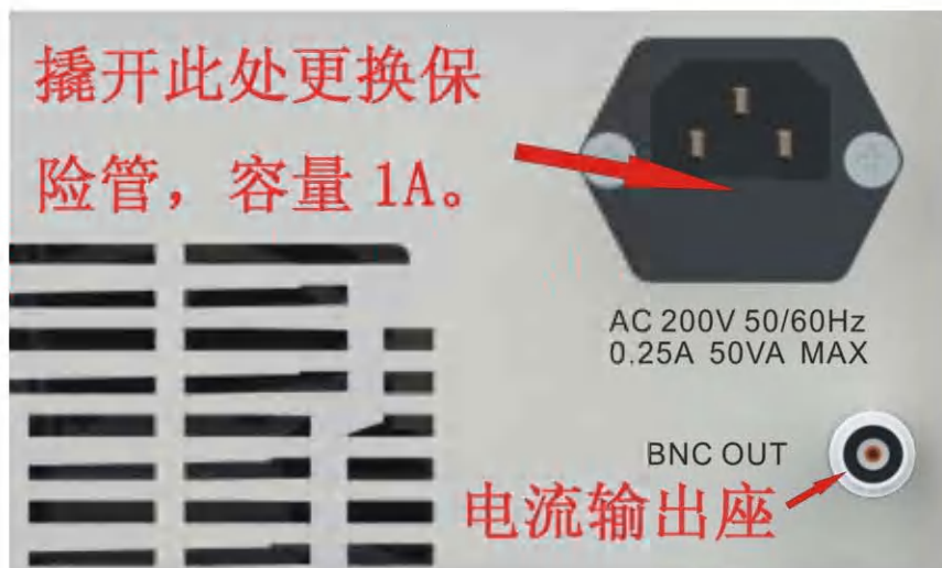
图 4-7 220V 电源输入插座和 BNC 输出座
