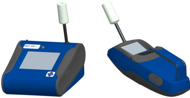
图 4-1: 在进样口上安装调零过滤器
