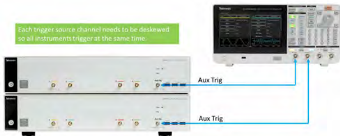
使用手动时延校正和辅助触发输入，在 200 ps 内同步多条仪器通道
