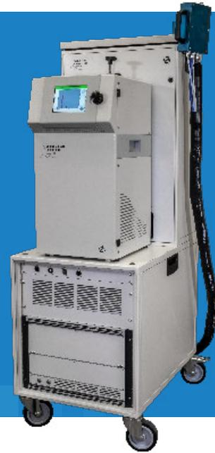
**使用者可以在单一用户界面监控排放控制装置，同时对发动机的瞬态响应进行精确测量。**
