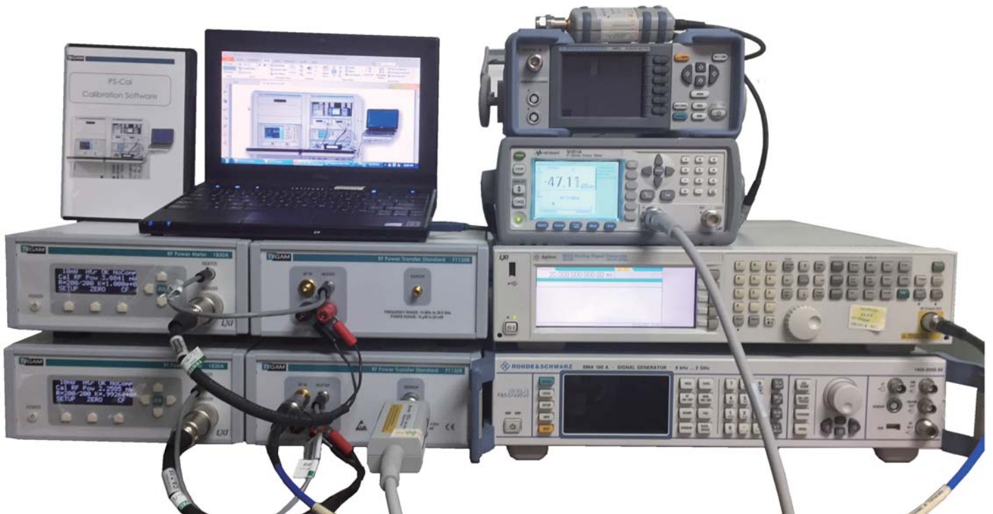
图2 使用PS-CAL自动校准软件的功率校准系统
