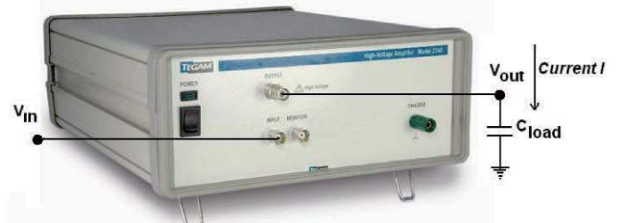
上图：容性负载，在电压放大器的输出端， 电流随频率升高而增大
