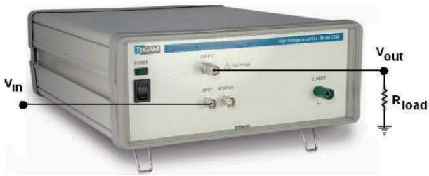
上图：纯电阻性负载，在电压放大器的输出端
