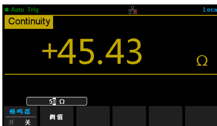
图 2- 7设置短路电阻
