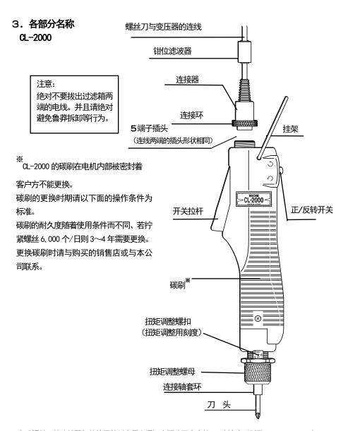
电动螺丝刀的连接器仅能使用苏州中日兴通讯有限公司生产的 5P 连接头(型号 NS-1605-02 RG)
