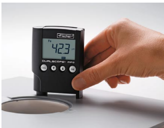
测量铁上油漆的厚度
