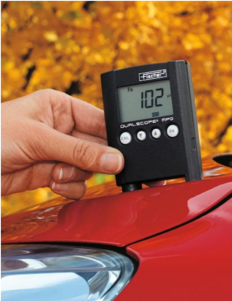
使用DUALSCOPE MPO检测油漆厚度，例如：汽车车身
