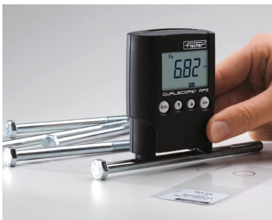
测量铁上镀锌层的厚度，测量小曲率工件必须进行校准以获得准确的测量结果
