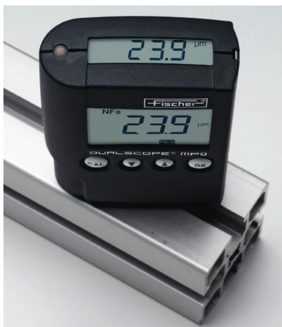
测量铝上阳极氧化膜的厚度
