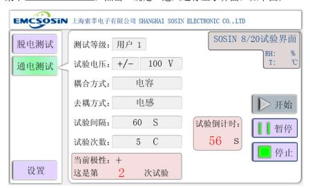
该界面会显示当前试验极性、试验倒计时和试验进度,用户会非常直观的得到试验进行的相关信息。此界面下,点击 按钮,试验进入暂停状态,高压充电停止,倒计时停止,记录当下的参数和状态,若点击按钮,试验接着暂停前的状态继续进行;若点击 按钮,试验接着暂停前的状态继续进行;若点击 按钮,高压结束充电,试验停止,屏幕返回为参数设置界面;试验完成,屏幕弹
