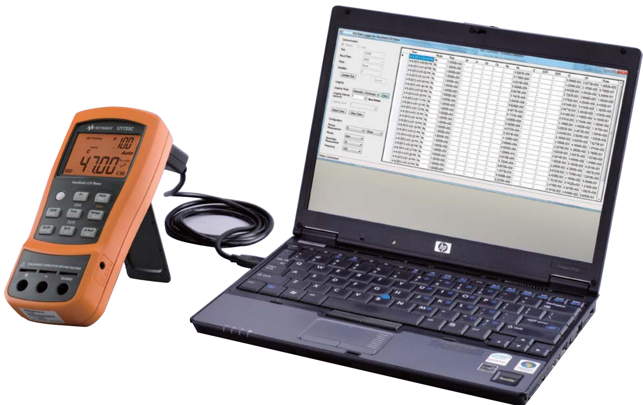
图 1. 将 1731C/U1732C/U1733C 与 PC 连接, 即可自动记录连续读数
