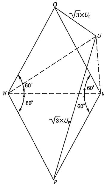
图 1 电压不平衡因数确定
