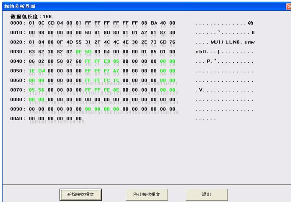
在进行电子式互感器数字输出测试时，单击
