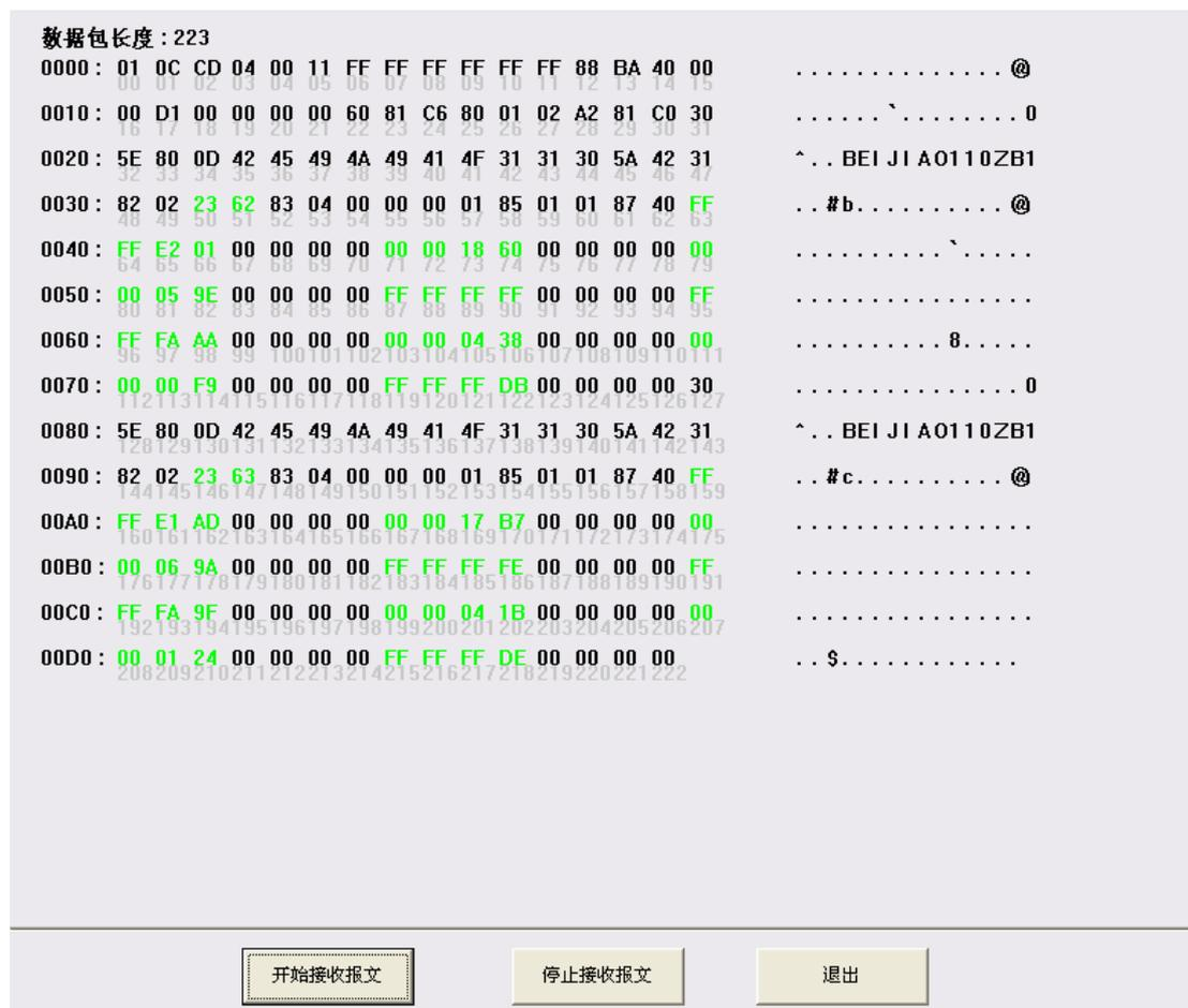
上图是抓取的博电公司 PWF-II 型的光数字继电保护测试仪输出的 9 - 2 报文，报文基本配置信息如下：
