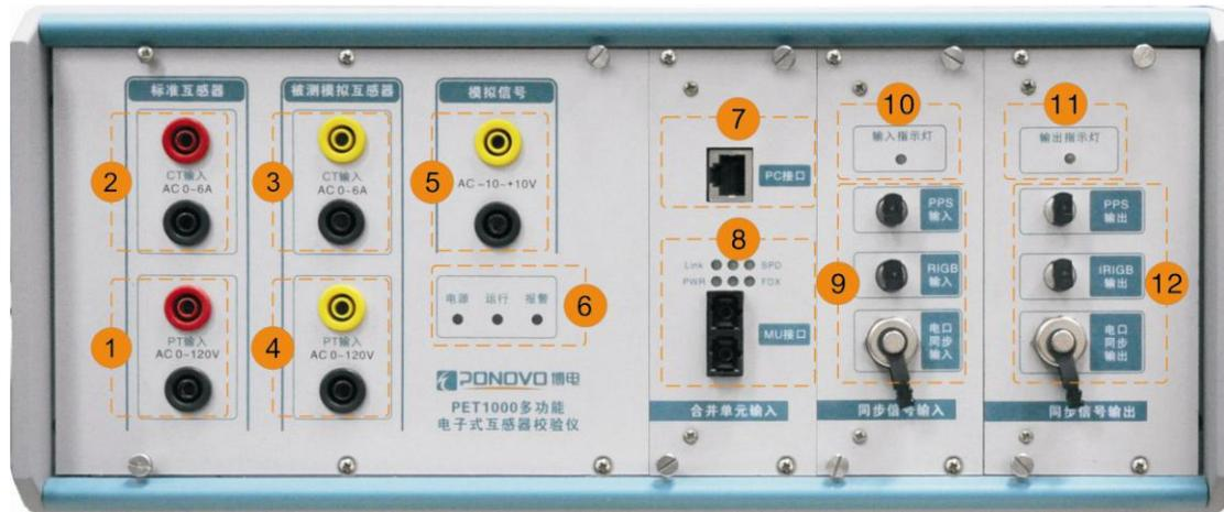
图 1-1 PET1000 多功能电子式互感器测试仪前面板
