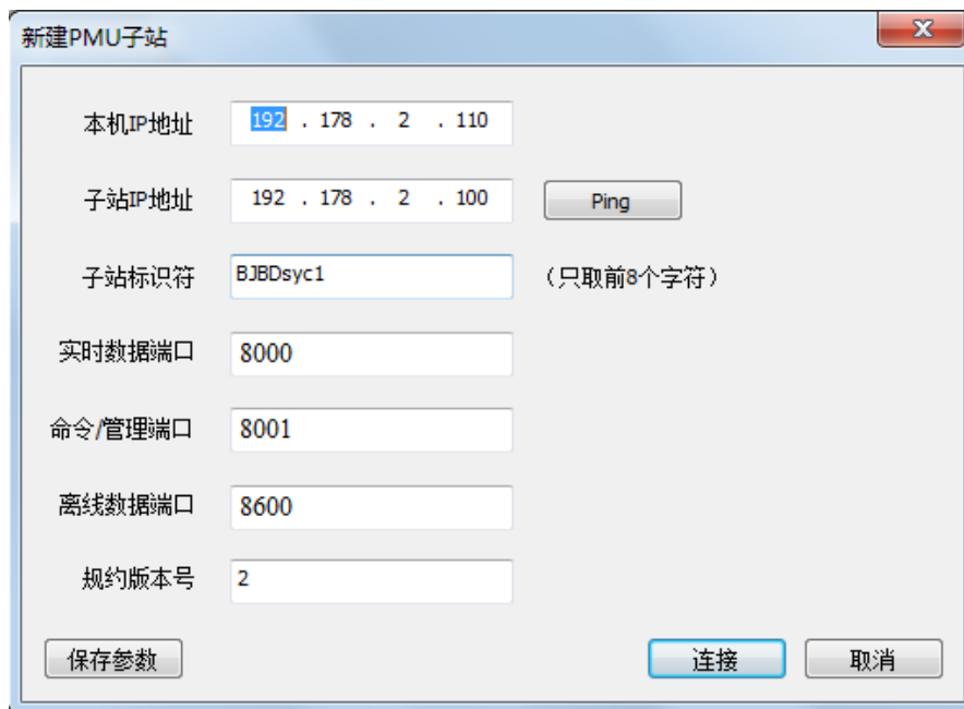
图 3-3 连接 PMU 子站对话框
