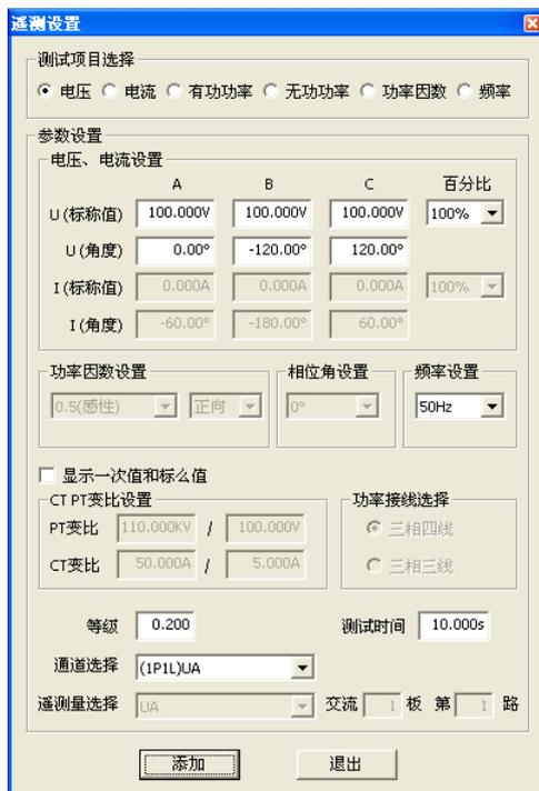
图 5-6 添加电压遥测点
