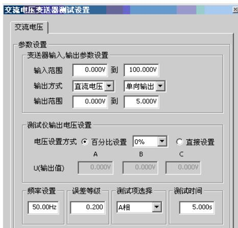
图 6-4 变送器校验：添加电压校验点
