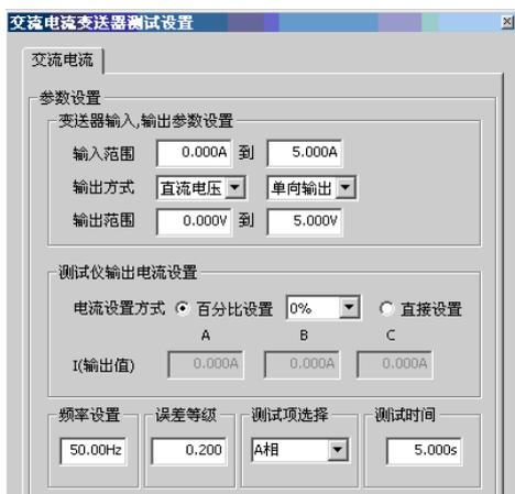
图 6-5 变送器校验：添加电流校验点
