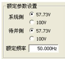
图 7-14 系统参数：额定参数
