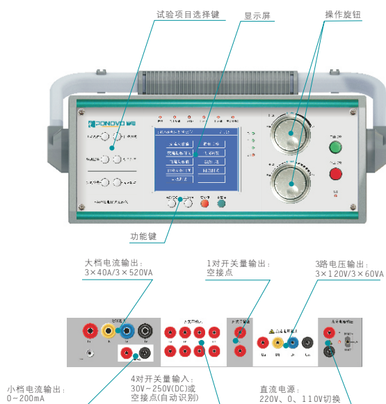
S40A前面板及接线端子示意图
