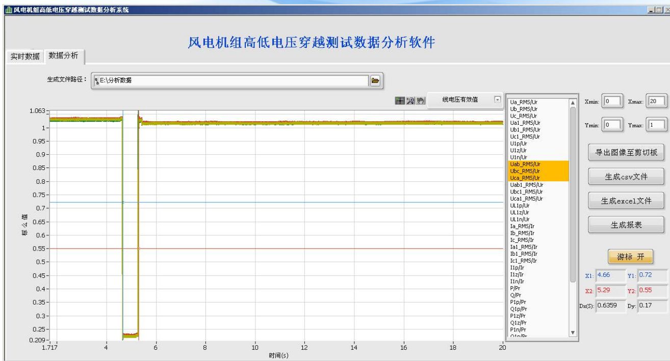
图 5-5 波形展示功能应用：电压有效值
