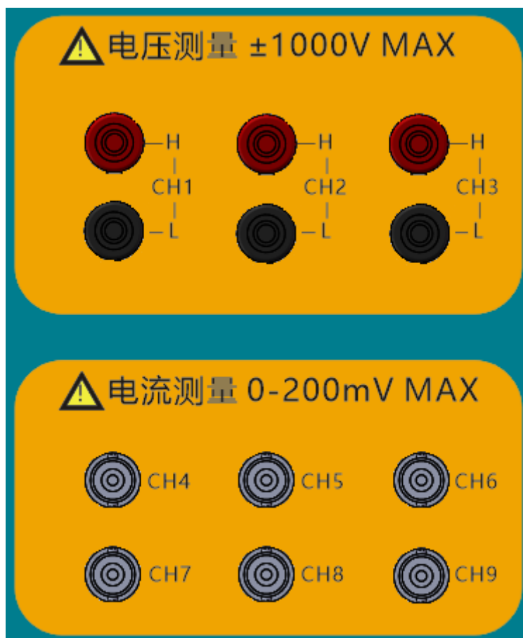
前面板电压、电流采集测量接线示意图
