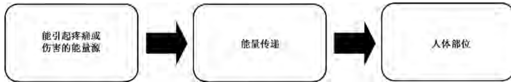
图1 疼痛和伤害的三框图模型
