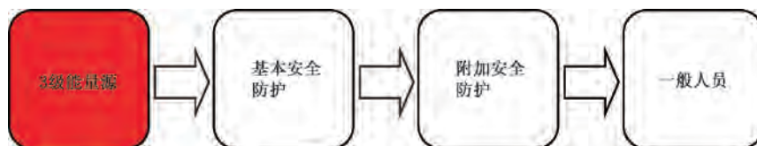
图12 防止3级能量源伤害一般人员的保护模型
