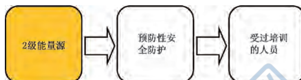
图 14 防止 2 级能量源伤害受过培训的人员的保护模型
