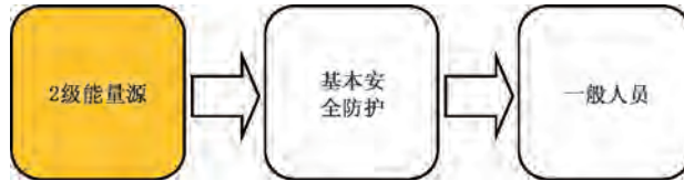
图10 防止2级能量源伤害一般人员的保护模型
