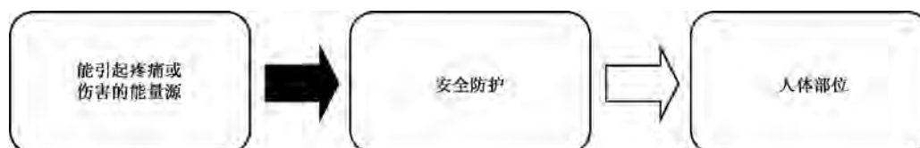
图 2 安全的三框图模型
