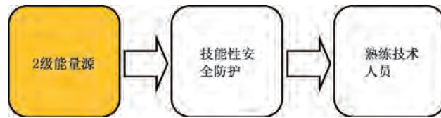
图 17 防止 2 级能量源伤害熟练技术人员的保护模型
