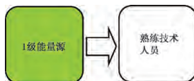
图 16 防止 1 级能量源伤害熟练技术人员的保护模型
