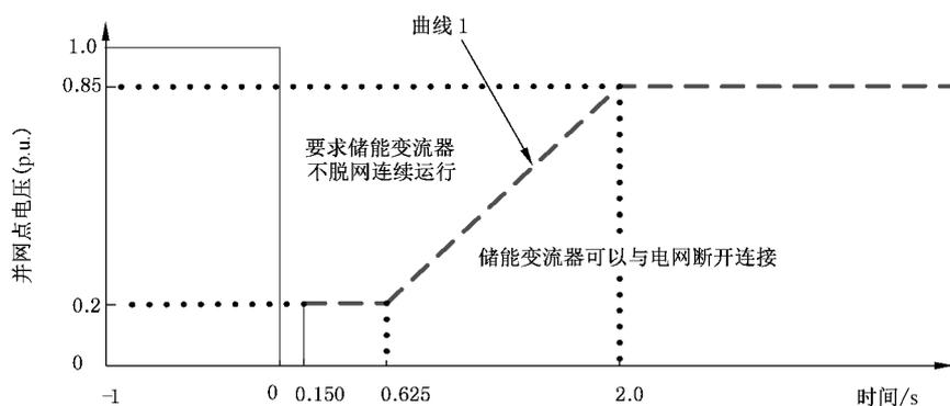
注 1: 对于三相短路故障和两相短路故障,考核电压为并网点线电压;对于单相接地短路故障,考核电压为并网点相电压。
