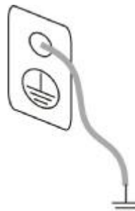
(b) 通过后面板接地端子接地
