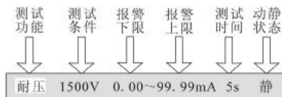
图 4-4-6 耐压测试设置界面
