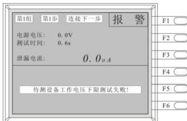
图 4-22 待测设备工作电压下限报警
