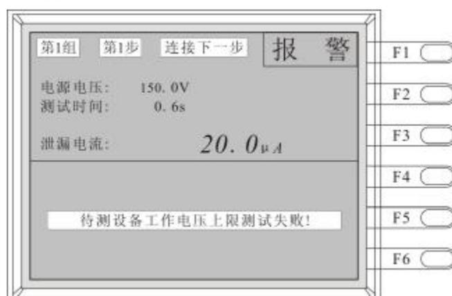
图 4-21 待测设备工作电压上限报警
