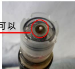
(6) 更换膜组后，进行100%的空气校正。
