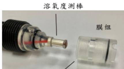
(5) 安装半透膜套组及充填电解液后，如发现半透膜套组内有小气泡是正常的。但正中间的工作区不可以有泡泡。
