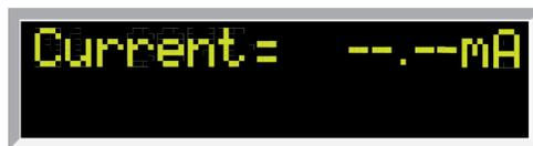
旋轉並按下飛梭旋鈕，將標準交流電流表的讀數輸入測試器。輸入所有數字後，測試器將前進至下一個校正點。
