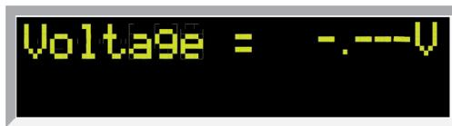
旋轉並按下飛梭旋鈕，將標準交流電壓表的讀數輸入測試器。輸入所有數字後，測試器將前進至下一個校正點。
