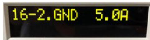
按下前面板的測試按鈕。測試器將在輸出連接器上提供約40 Amperes，螢幕將顯示：
