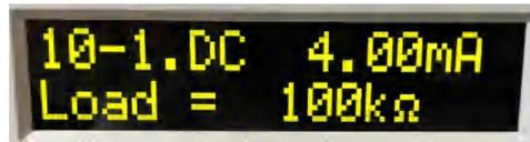
按下前面板的測試按鈕。測試器將在輸出連接器上提供約400VDC，螢幕將顯示：
