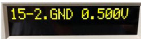
按下前面板的測試按鈕。測試器將在輸出連接器上提供約0.5Vac，螢幕將顯示：
