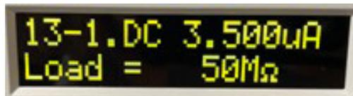
按下前面板的測試按鈕。測試器將在輸出連接器上提供約175Vdc，螢幕將顯示：
