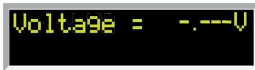
旋轉並按下飛梭旋鈕，將標準交流電壓表的讀數輸入測試器。輸入所有數字後，測試器將前進至下一個校正點。
