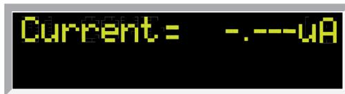
旋轉並按下飛梭旋鈕，將標準直流電流表的讀數輸入測試器。輸入所有數字後，測試器將前進至下一個校正點。
