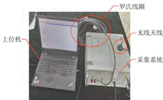
图 9 系统硬件测试平台搭建
