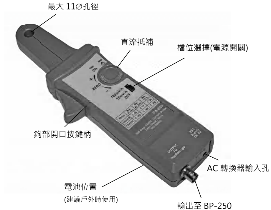
圖 1: PA-629 電流探測鉗上的控制及指示。
