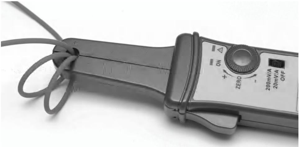
圖 4:提高電流靈敏度方式
