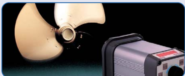
空调室外机风扇旋转状态检查
