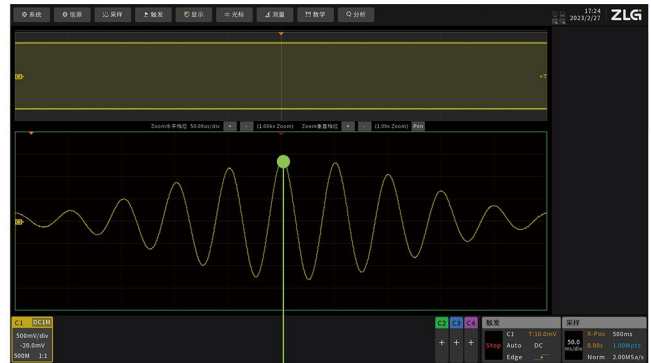
1M存储深度，捕获500ms波形，采样率下降至2MHz，波形已经完全失真
