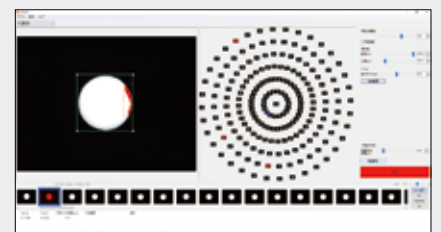
喷淋头孔异物检查
