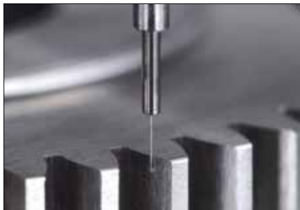
模数0.8 标准齿轮测量实例
