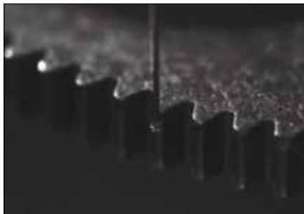
MPP-NANO \phi 0.125\text{mm} 测针测量实例
