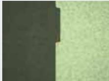
倍率低无法对细微的凸出形状宽度进行准确的测量
