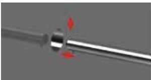
使用微动旋钮(手动)的小孔测量的定位示意图
